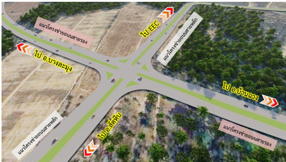
รูปที่ 7-9 จุดตัด กม.ที่ 4+404 ตัดกับถนนสายรอง (ทางแยกสัญญาณไฟจราจร)
