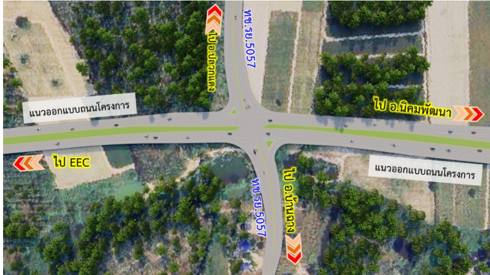
รูปที่ 7-5 จุดตัดกับ รย.5057 (ทางแยกสัญญาณไฟจราจร)
