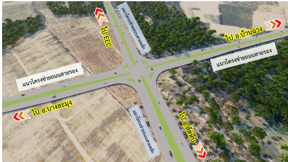
รูปที่ 7-14 จุดตัด กม.ที่ 7+103 ตัดกับถนนสายหลัก (ทางแยกสัญญาณไฟจราจร)
